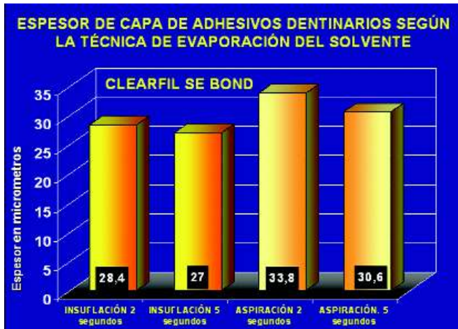
Gráfico 3. Valores en micrómetros del espesor de capa del Clearfil SE Bond, según la metodología empleada para la evaporación del disolvente.
