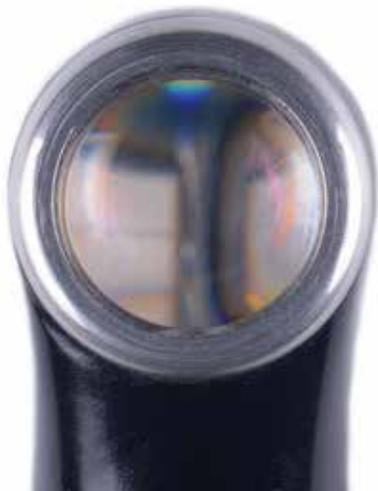
FIGURA 11. Extremo final de una lámpara en forma de lápiz donde se observa un lente (placa difusora) que cubre los diodos LED ordenados en chips. Valo (Ultradent Products Inc., South Jordan, EUA).
